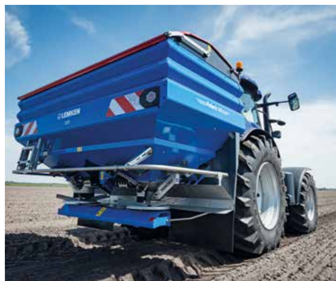
Hydraulische aandrijving voor een constante draaisnelheid van de schijven, ook op hellingen
