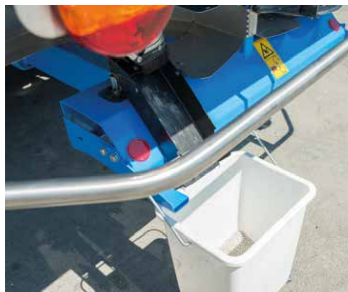
Afdraairoefset bestaande uit afdraaigoot, afdraaibak en instelschuif
