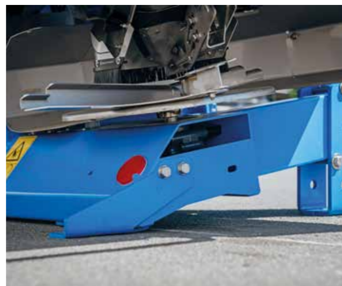
Parkeersteunen maken aanhangen en loskoppelen gemakkelijker en pallets overbodig
