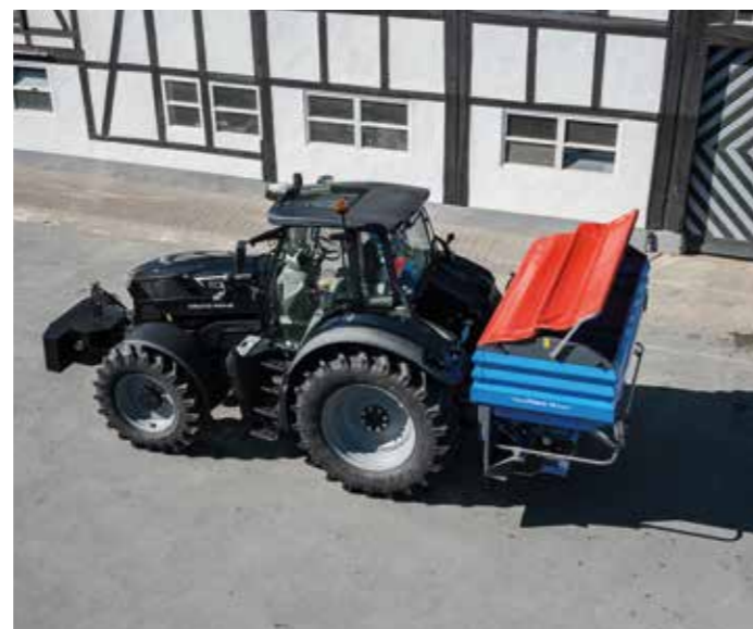
Oprolbaar afdekzeil in handmatige of hydraulische uitvoering
